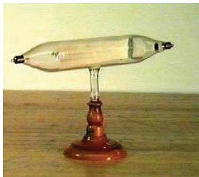
metálicos, uno negativo llamado *cátodo* y el otro positivo llamado *ánodo* a una fuente eléctrica de alto voltaje, pudo observar la fluorescencia en las paredes del tubo que causaban los rayos. Observó que los rayos que se producían partían del cátodo y se transportaban hasta el ánodo, no importando el material de que estuviese hecho el cátodo, por lo que los llamó *rayos catódicos*.
