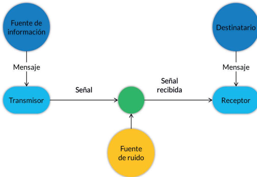
Figura 1.1 Modelo del proceso de comunicación.
