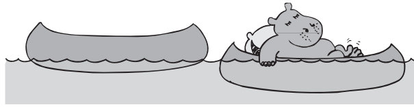
FIGURA 13.17 El peso de un objeto flotante es igual al peso del agua que desplaza su parte sumergida.
