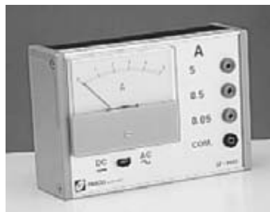
FIGURA 24.18 Tanto el amperímetro como el voltímetro son básicamente galvanómetros. (En el amperímetro, la resistencia eléctrica del instrumento es muy baja, y en el voltímetro es muy alta.)
