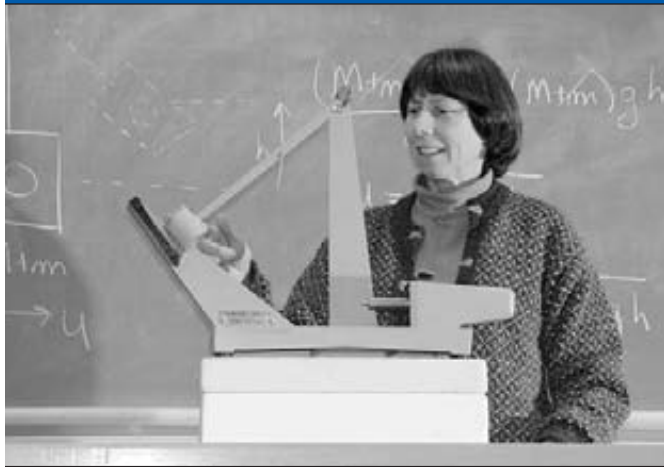
Annette Rappleyea usa un péndulo balístico para calcular la rapidez de un balín que se dispara.
