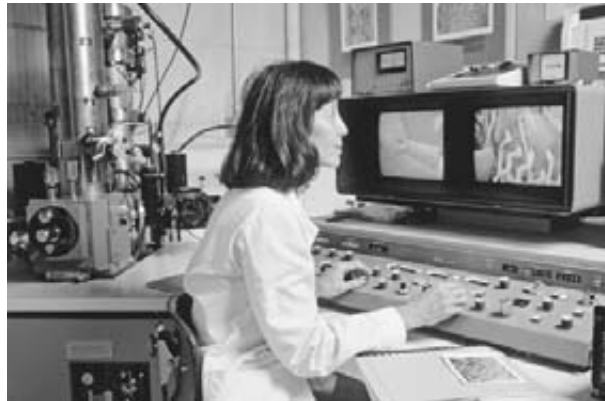
FIGURA 31.9 En un microscopio electrónico se aprovecha la naturaleza ondulatoria de los electrones. La longitud de onda de los haces de electrones suele ser miles de veces menor que la de la luz visible, de manera que con el microscopio electrónico se distinguen detalles que no se observan con los microscopios ópticos.
