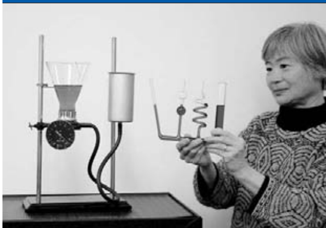
Tsing Bardin demuestra la dependencia de la presión del agua y la profundidad.
