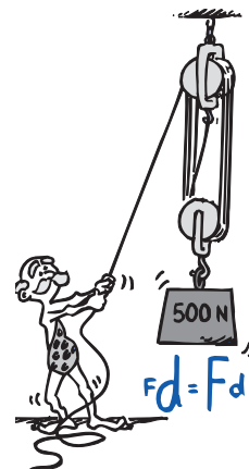
FIGURA 7.17 Fuerza aplicada \times distancia aplicada = fuerza producida \times distancia producida.
