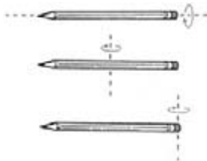
FIGURA 8.10 El lápiz tiene distintas inercias rotacionales respecto a los distintos ejes de rotación.
