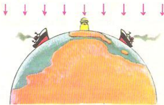
FIG. 93. El buque de la izquierda tiene una diferencia de dos horas con Greenwich. Como su hora es antemeriidiano, ello indica que está a 30^\circ al oeste. El de la derecha, en cambio, tiene igual diferencia de hora, pero al ser p. m. su longitud es este. Cada hora de diferencia representa 15^\circ de longitud. ¿Por qué?
