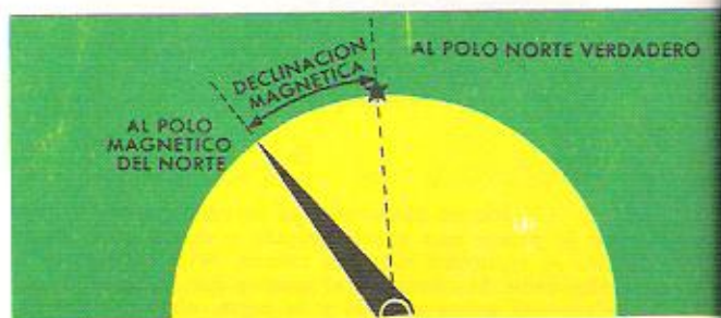
FIG. 74. La declinación magnética se mide en grados y representa el ángulo que forma la aguja de la brújula al señalar en dirección al polo magnético del hemisferio correspondiente.
